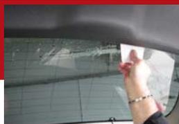
Pour chasser l'air et le liquide, enrouler la raclette dans un chiffon absorbant et la passer sur la face externe du film en partant du centre vers l'extrémité en commençant par la partie supérieure. Il faut appuyer assez fortement sur la raclette tout en tenant le film.
