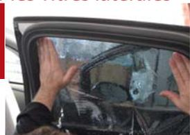
Baisser la vitre de +/- 3cm. Retirer en partie le film de protection (en garder +/- 10cm). Faire glisser le film de façon à le positionner correctement sur la vitre avec un retrait de 2 mm par rapport à l'arrondi du vitrage (s'il ne glisse pas, mouiller à nouveau le film et la vitre). Maroufler horizontalement.
