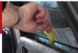
Remonter la vitre. Mouiller abondamment le vitrage non filmé et retirer le film de protection. Faire rentrer le film légèrement à l'intérieur des joints à l'aide de la raclette Conquistador ou de l'écarteur de joint (Edge). Maroufler la partie basse, puis passer la raclette à l'intérieur des joints.
